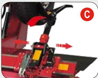
(FR) **VERSION TECO 570 S:** translation automatique à 2 vitesses du chariot porte-outils simultanée au mouvement automatique du mandrin et soulèvement hydraulique du bras porte-outils contrôlés par l'unité portable de commande. La rotation des outils est obtenue manuellement par un pédale de dégagement dédié.
