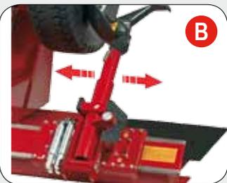
(FR) **VERSION TECO 570 N:** translation automatique à 1 vitesse du chariot porte-outils contrôlée par l'unité portable de commande et simultanée au mouvement automatique du mandrin. Soulèvement et rotation des outils de travail obtenus manuellement par un dispositif de dégagement dédié.
