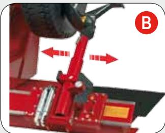
(ES) **VERSIÓN TECO 570 N:** translación automática a 1 velocidad del carro porta-útiles controladas por la unidad de mando portable y simultánea al movimiento automático del mandril. Levantamiento y rotación de los útiles obtenidos manualmente por medio de un dispositivo de desbloqueo dedicado.
