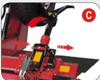
(ES) **VERSIÓN TECO 570 S:** traslación automática a 2 velocidades del carro porta-útiles simultánea al movimiento automático del mandril y levantamiento hidráulico del brazo porta-útiles controlados por la unidad de mando portable. Rotación de los útiles obtenida manualmente por medio de un pedal de desbloqueo dedicado.
